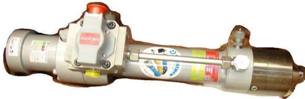
Eje Pitch and Roll: 2 Cilindros Hanchen con Servos Moog
