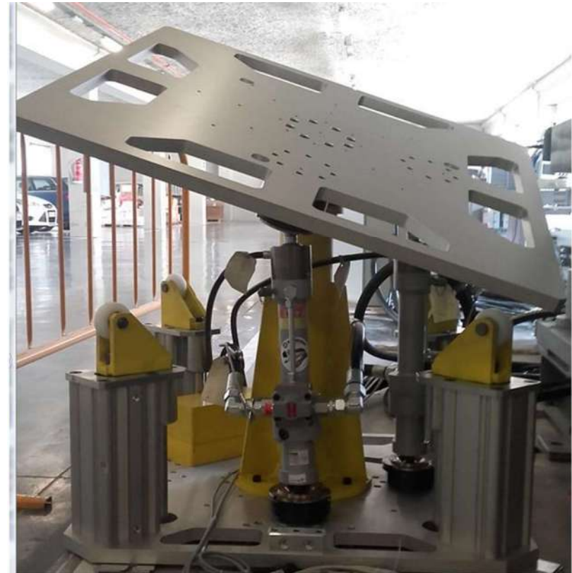
Eje Pitch and Roll: 2 Cilindros Hanchen con Servos Moog
